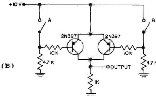
GATE USING PNP TRANSISTORS
