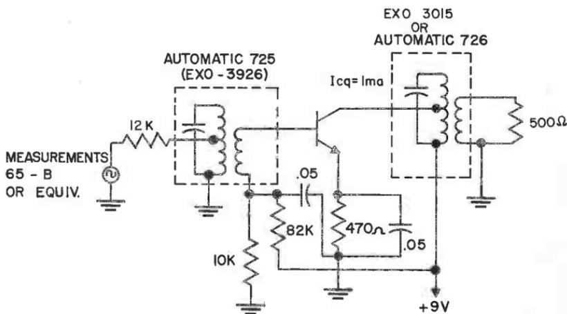
**TYPICAL IF TEST CIRCUIT**
