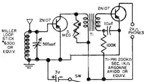
TWO TRANSISTOR RADIO RECEIVER
