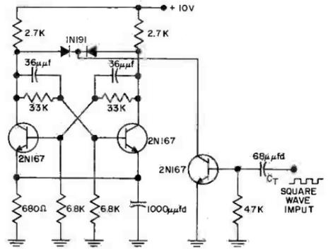
COLLECTOR TRIGGERING WITH TRIGGER AMPLIFIER
