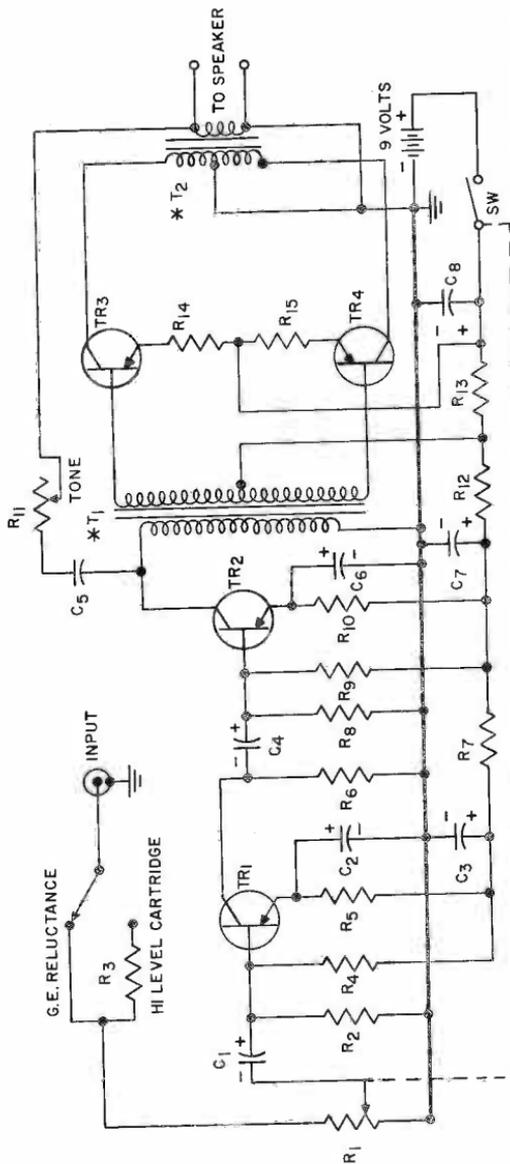
MAXIMUM POWER OUTPUT : .75 WATTS
