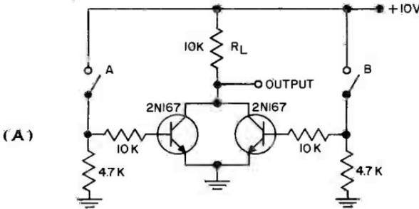
GATE USING NPN TRANSISTORS
