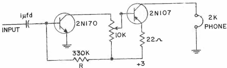
R SHOULD BE ADJUSTED FOR OPTIMUM RESULTS
