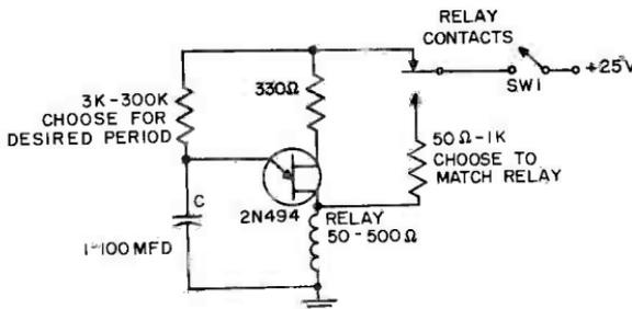
**TIME DELAY CIRCUIT WITH RELAY**
